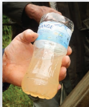
De bron Nyamaraba: opvang water via draineerbuizen – gelegen op 1945 m (Thommen) - matig debiet 0.5 l/sec - troebel water - drassige omgeving wat doet vermoeden dat draineerbuizen verstopt zijn en slechts een deel van het totale debiet van de bron opvangen.
